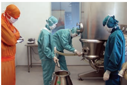
Підготовка процесу грануляції в киплячому шарі
